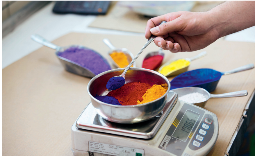
Bild 1. Damit die Compounds trotz Additiven und Verarbeitungseinflüssen in der späteren Anwendung die richtigen Farben haben, werden individuelle Pigmentmischungen angesetzt. Standardmäßige Farb-Masterbatches sind dafür nicht präzise genug (© Bada)
